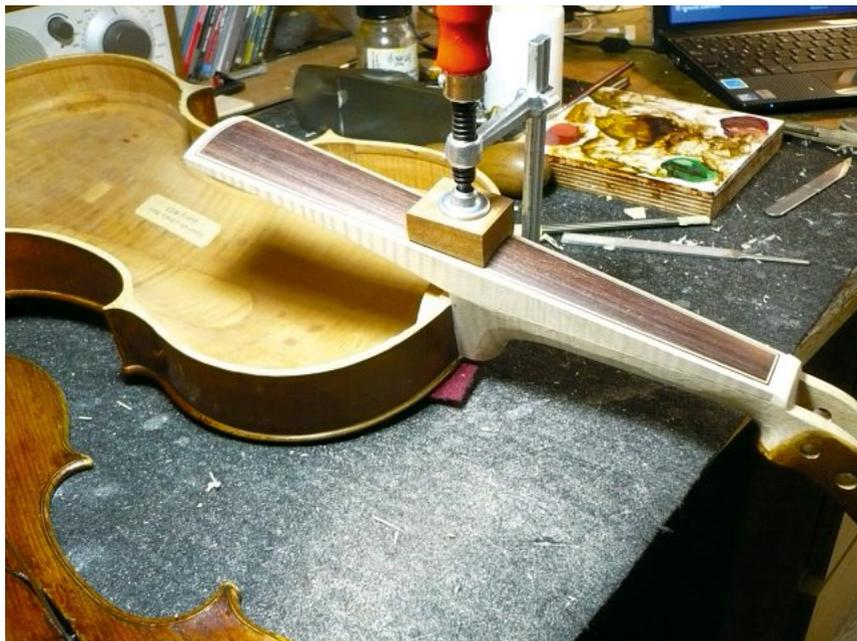
*Viola beim Einpassen des Barockhalses mit gut sichtbarem keilförmigen Griffbrett*
